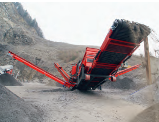
Mit dem 3-Deck Siebkasten können drei qualifizierte Endkörnungen ausgesiebt werden
