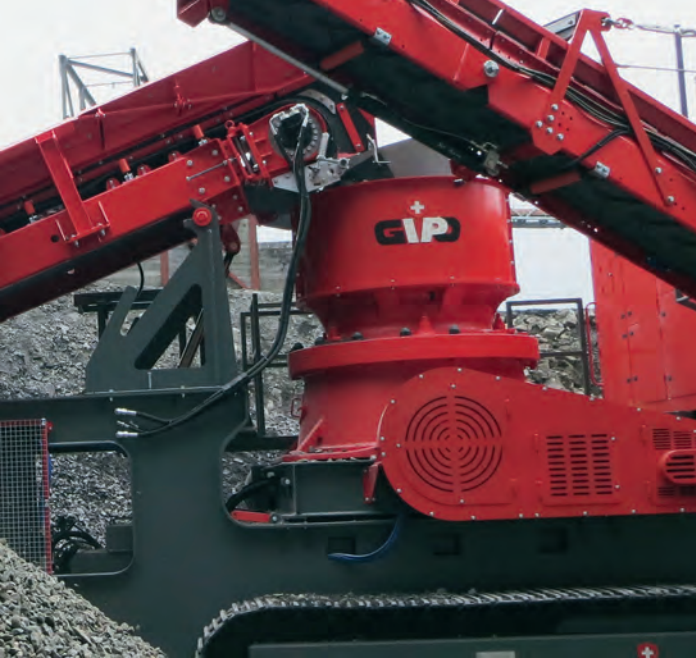
Der GIPO-Kegelbrecher im Hartgesteinseinsatz (3900 kg/cm 2 )
