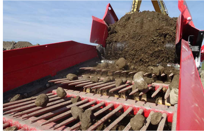
Siebdeck mit Fingersieb / Screening deck with finger screen / Étage de criblage avec crible à doigts
