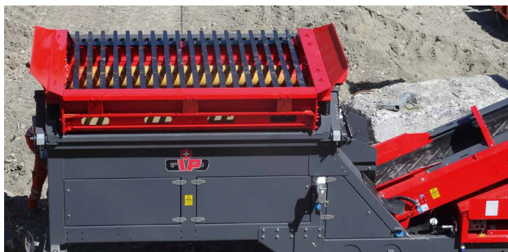
Aufgabetrichter mit Kipporost / Feed hopper with grid opening / Trémie d'alimentation avec grille basculante
